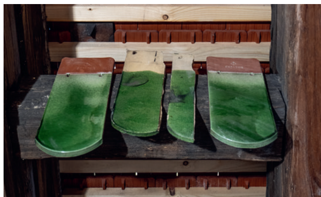
Alte und neue Biberschwanzziegel für die Deckung des Dachs.
