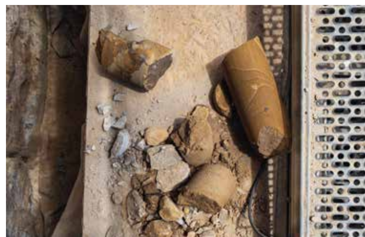
Kernbohrungen zur vorbereitenden Analyse von Gesteinsschichten.
